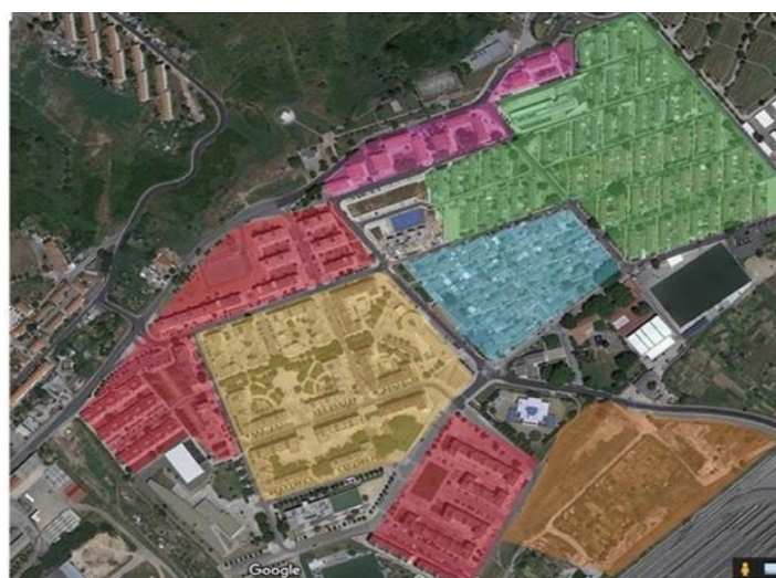
Figura 1. Mapa das fases de construção do bairro Padre Cruz em Lisboa. Na cor de laranja, as primeiras casas do bairro, construídas em 1959 e demolidas no final dos anos 80; na azul, as alvenarias de piso térreo e na verde, as alvenarias em duplex (ambas construídas entre 1961 e 1962); na cor-de-rosa, os primeiros lotes construídos em 1975-1976; em amarelo e vermelho, os lotes do programa habitacional PIMP, construídos entre 1989 e 1999. Fonte: elaboração pessoal a partir da base cartográfica do Google Earth.
